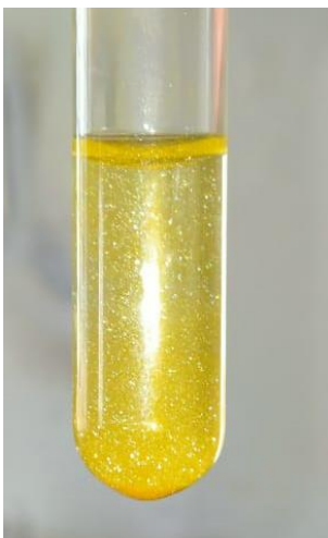
Рис. 1. Пробирка № 1 – качественная реакция на катион свинца (II)
