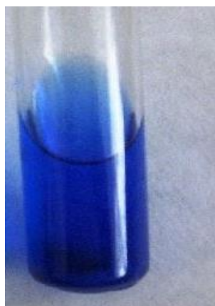
Рис. 2. Пробирка № 2 – качественная реакция на катион меди (II)
