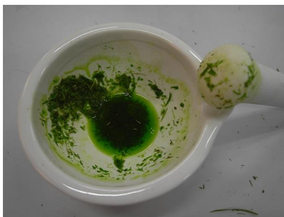
Рис. 2. Измельчение образца в фарфоровой ступке и обмывка водой
